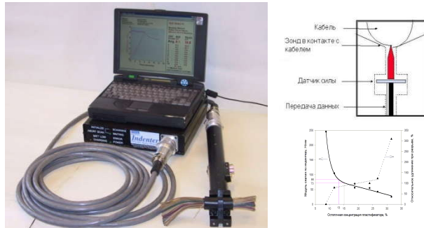
Кабельный индентор "EPRI/OGDEN" для диагностики контрольных кабелей
