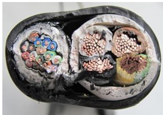
Рисунок 9. Срез образца кабеля марки КСнг(А)-HF (4×16)+9×(2×0,5)
