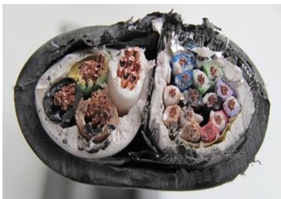
Рисунок 8. Срез образца кабеля марки КСнг(А)-HF (4×4)+7×(2×0,5)
