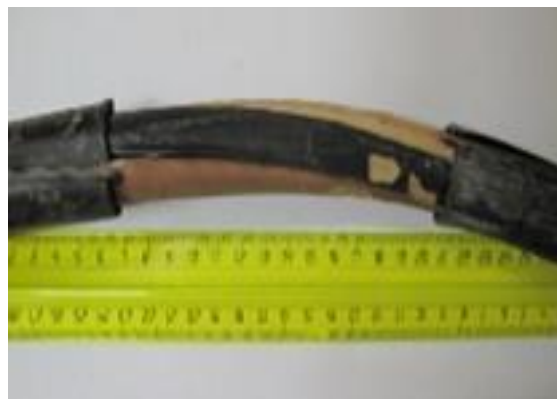
Рисунок 13. Модельный дефект – старение открытого участка изоляции силового кабеля
