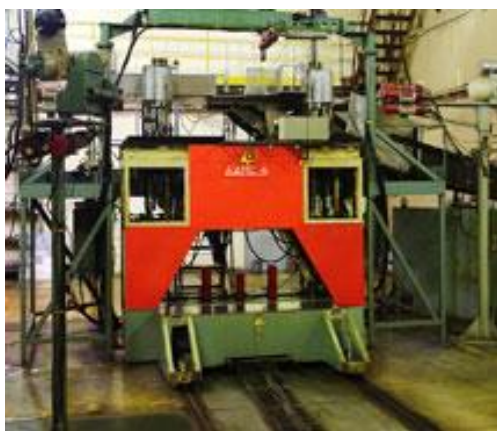
Двухзонный импульсный ядерный реактор «БАРС-4»
