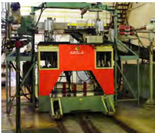
Двухзонный импульсный ядерный реактор «БАРС-4»
